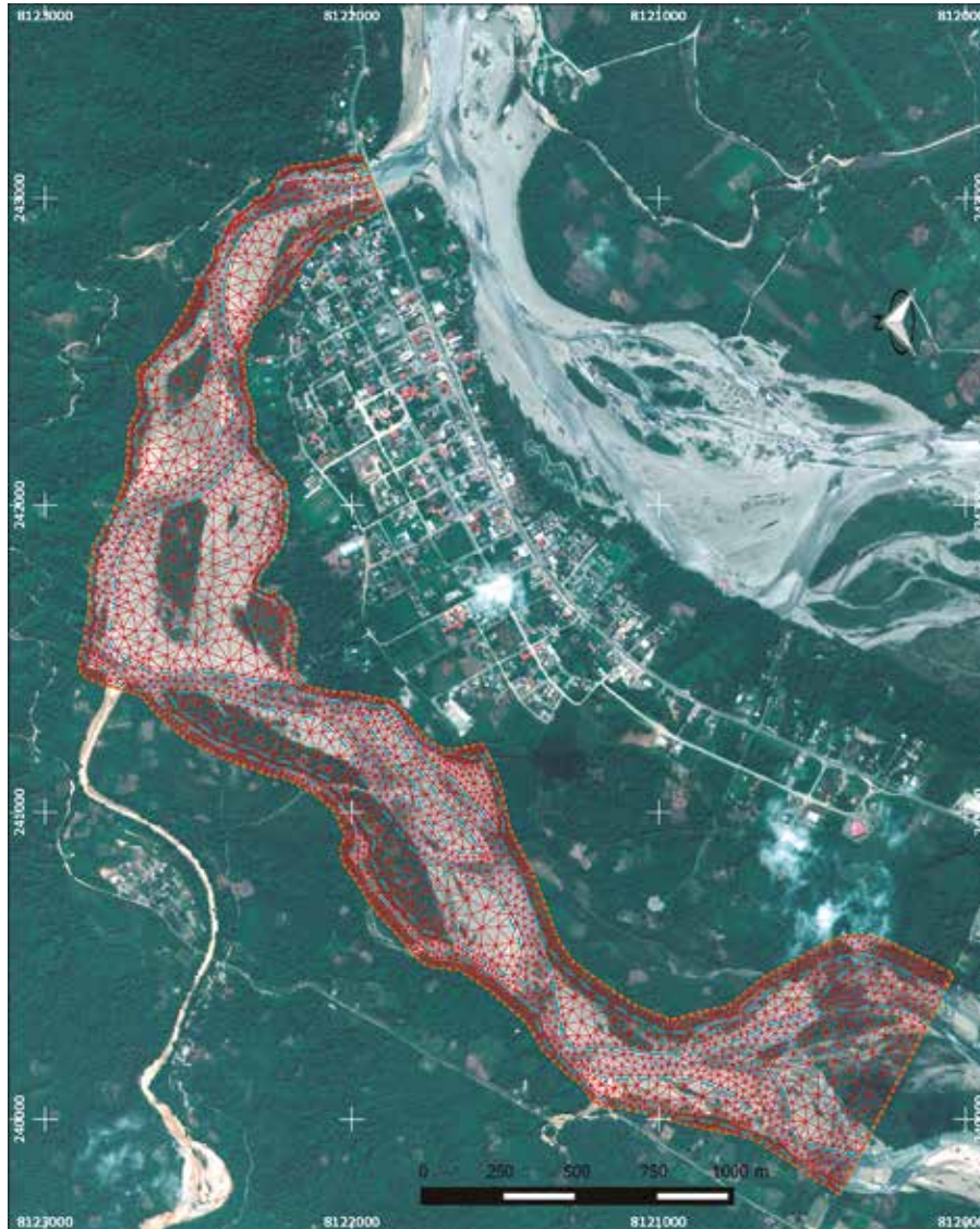
Figura 2. GENERACIÓN DE MALLAS EN CAUCES
